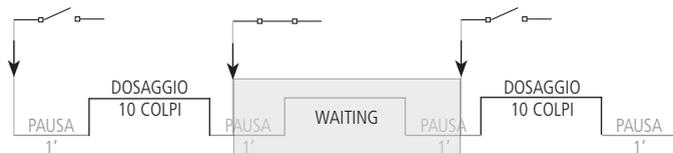
Fig. 25. Batch -mode internal- modalità di lavoro della pompa con ciclo pausa-lavoro regolato da un contatto esterno. Caso 2.
