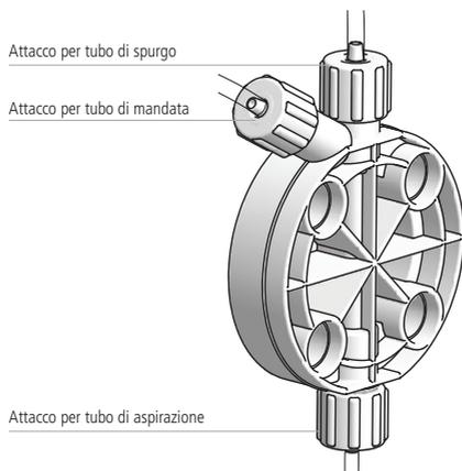
Fig. 10. Descrizione corpo pompa in PMMA autosurgito (pompa KMSA MF).
