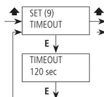
Questa impostazione è valida solo per le modalità di lavoro MULTIPLY, PPM, PERC e MLQ quando il risultato del calcolo è una moltiplicazione.
