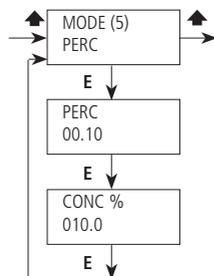
In questa modalità di lavoro, la pompa connessa ad un contatore lancia-impulsi, diventa anche **MISURATORE DI PORTATA Istantanea**.
