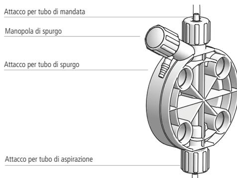
Fig. 8. Descrizione corpo pompa in PMMA con spurgo manuale (KMS MF).
