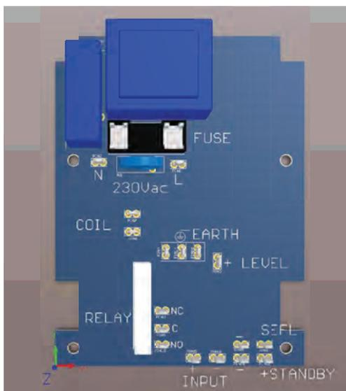
Fig. 46. Schema circuito KMS MF per la connessione ad un contatore lancia impulsi con effetto Hall
